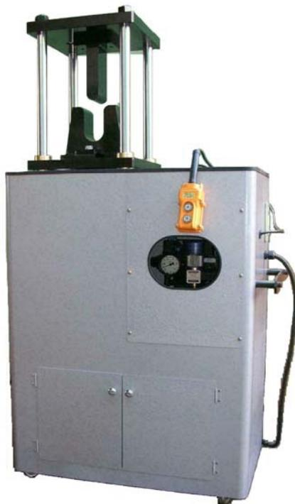
本試験機は、溶接技能訓練の課程で溶接継手の性能を簡易かつ迅速に測定評価するために開発された画期的なものです。
